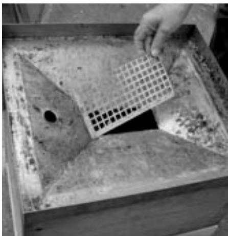
...Trichter aufsetzen, durch kleines Loch Tapetenablöseschlauch führen...
