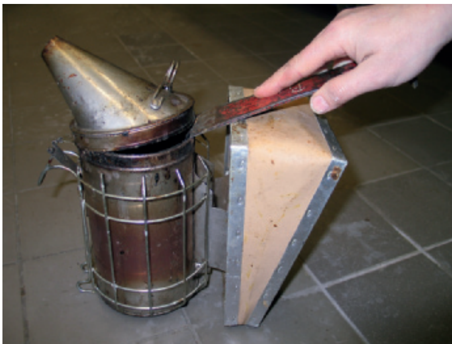
Abb. 1: Wenn's klemmt, leistet der Stockmeisel gute Dienste.
