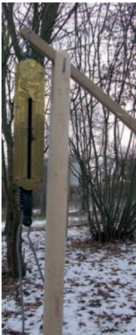
Federzugwaage am Stiel befestigen.
