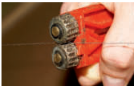
Mit einem Drahtspanner wird der Draht so verkürzt, dass er wieder optimal gespannt ist.
