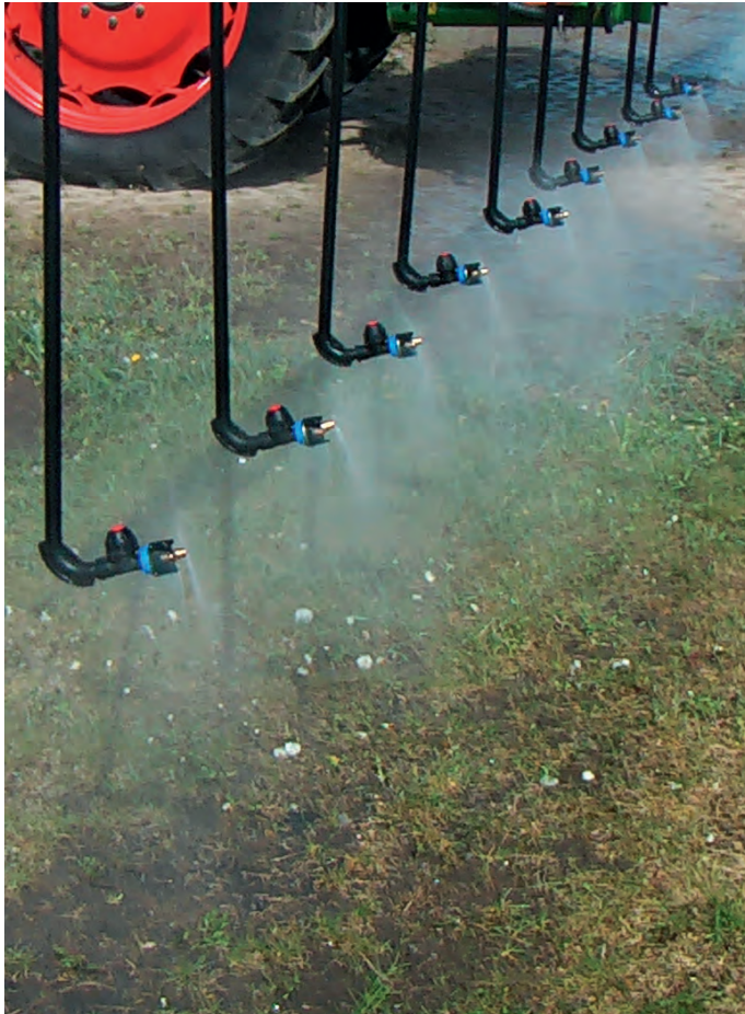
Spritzbild der abgehängten Düsen.
