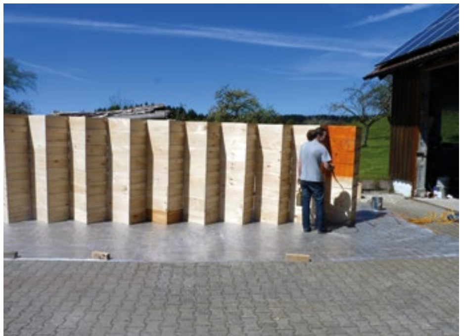
Abb. 06 - Zum Ansprühen stelle ich die Zargentürme Eck an Eck, so gibt es große Flächen und es geht weniger Farbe verloren.
