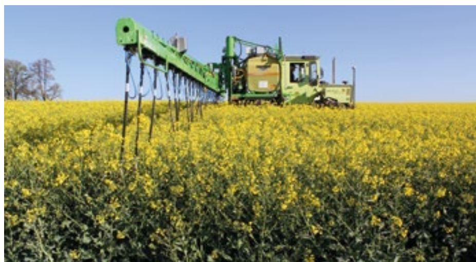
Abb. 04 - Abgehängte Droplegdüsen reduzieren Rückstände.
